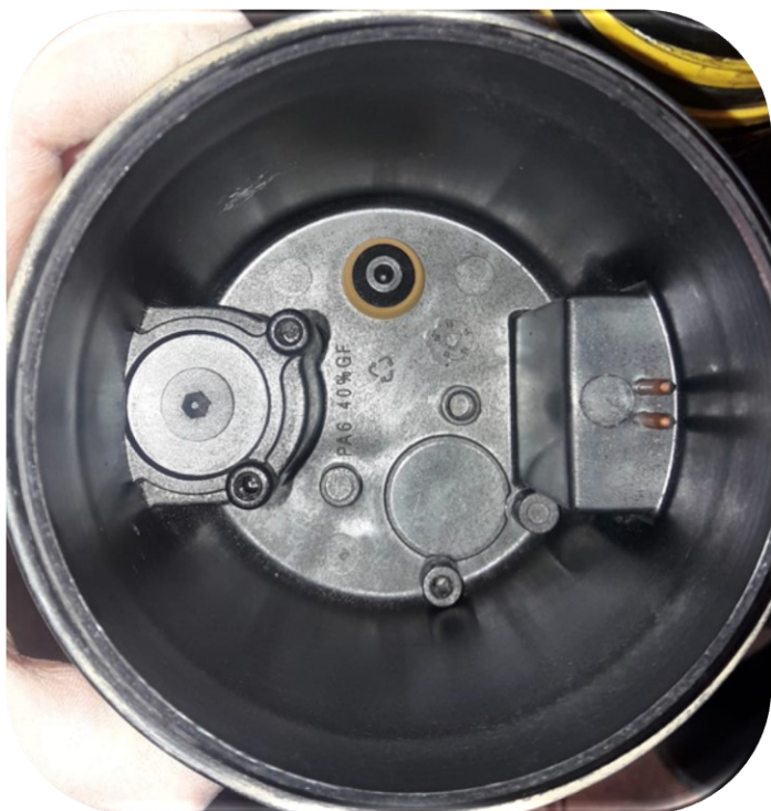
Foto linksonder, het filterhuis gereinigd met Petrol System Cleaner.
